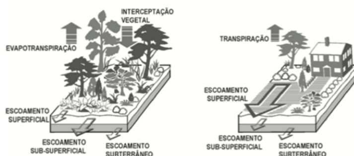
Figura 3.1: Alterações no balanço hídrico provocadas pela urbanização (ADASA (2018)).
