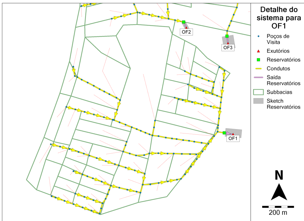
Figura 5.13: Detalhe do sistema de drenagem para OF1.
