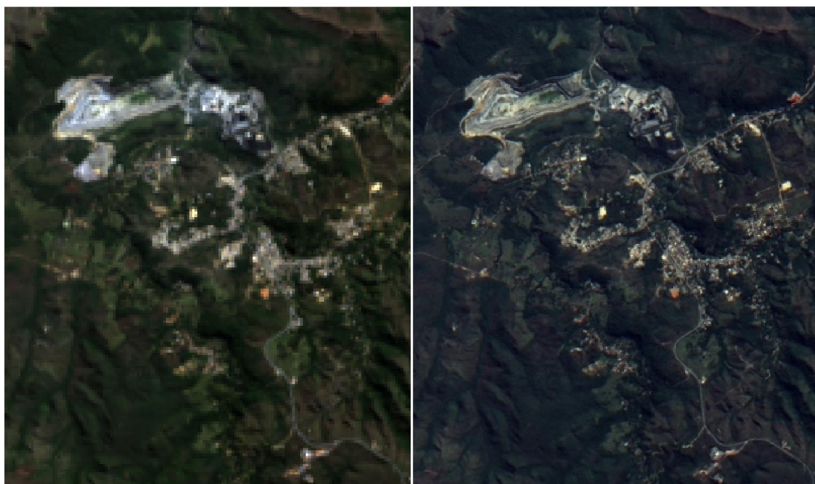
Figura 3.3 (a) Composição colorida RGB432 com resolução espacial de 30m; (b) Composição colorida RGB432 com resolução de 15m (após Transformação RGB-IHS)
