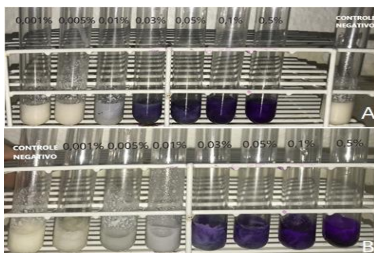
Figura 1: Desenvolvimento da reação colorimétrica observada na detecção de formol adicionado ao leite sem lactose (A) e com lactose (B), pelo teste Formfix2.0®.
