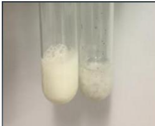
Figura 1: Comparação de resultado da adição do reagente Formfix2.0® em leite sem formol, à direita (precipitação) com leite sem adição do reagente.
