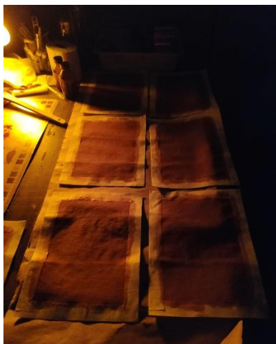
Figura 36 – Secagem dos tecidos após a aplicação da emulsão fotossensível.
