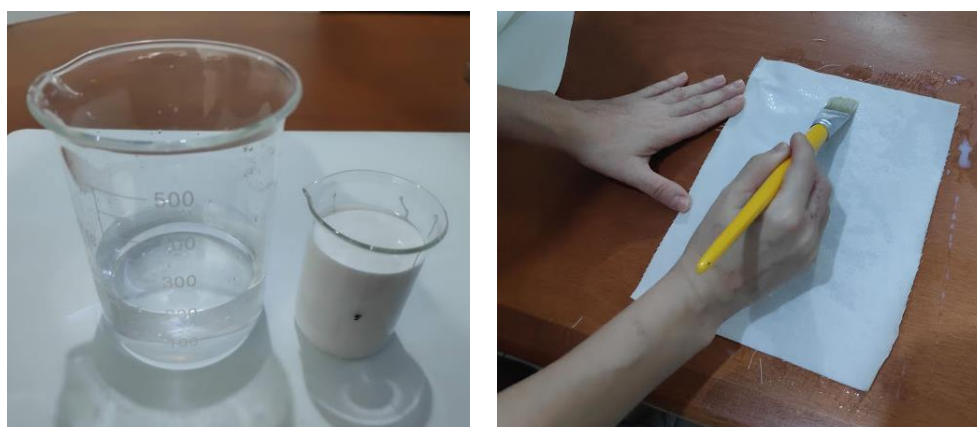
Figura 33 – Preparação do selador e aplicação sobre o tecido seco.
