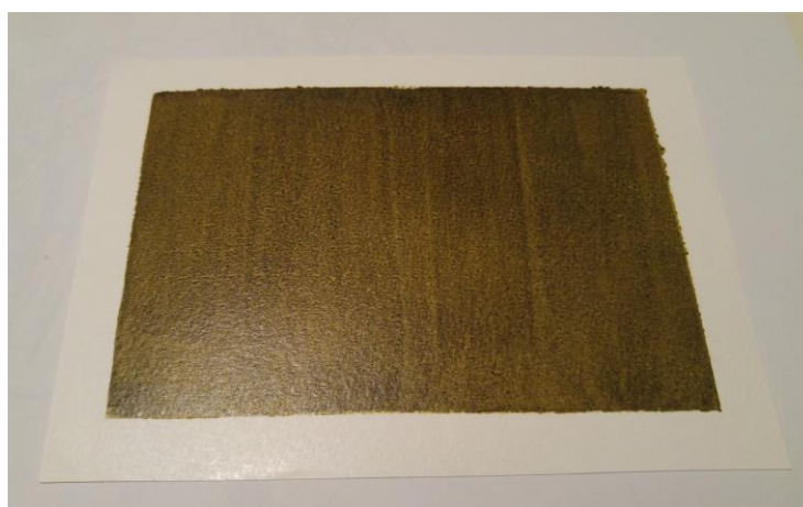
Figura 16 – Papel Canson Montval 300 g após a aplicação da substância fotossensível, em processo de secagem.
