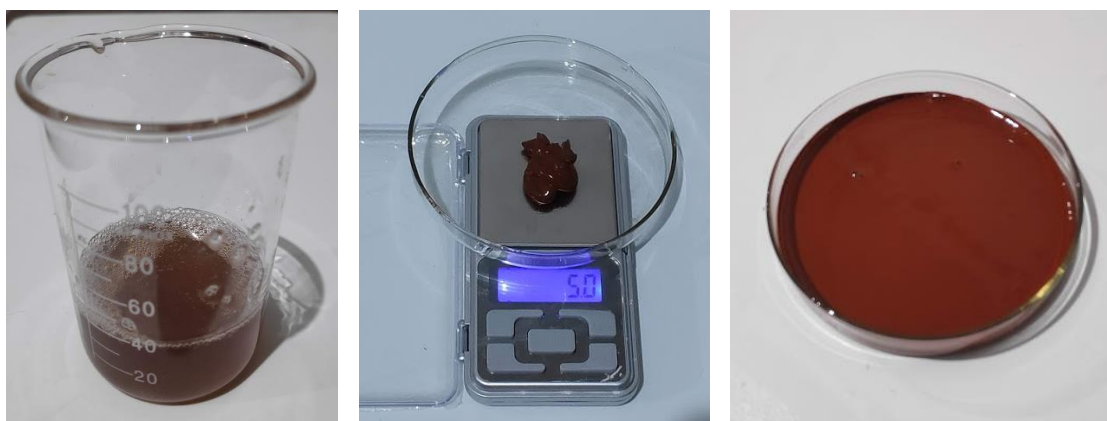
Figura 35 – Preparação da solução pigmentada com goma arábica diluída e aquarela.
