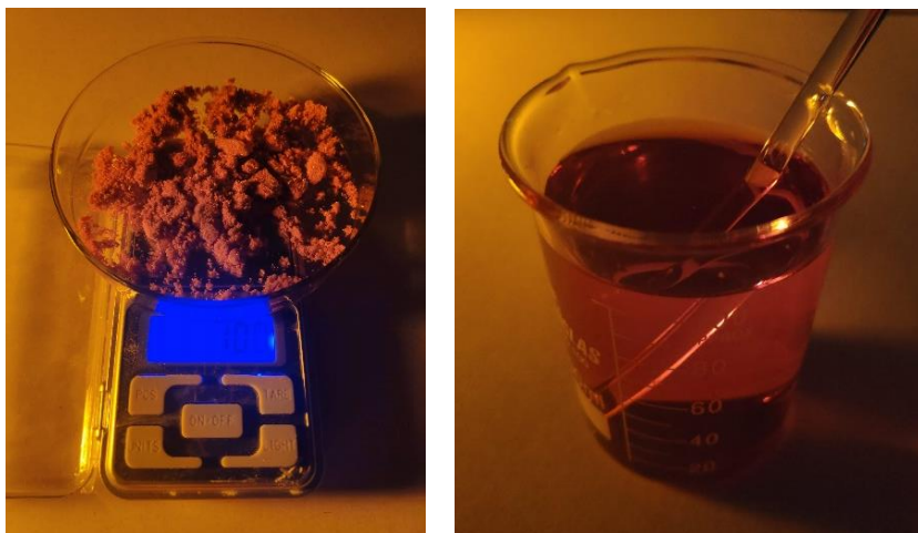
Figura 15 – Preparação da solução de dicromato de amônio.
