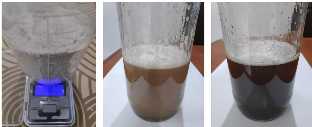
Figura 14 – Diluição da goma arábica em água destilada: logo após o preparo e no dia seguinte.
