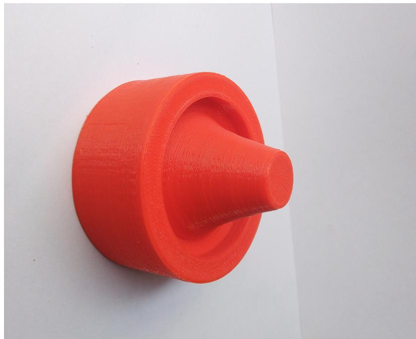
Figura 40 – Tubeira *aerospike* toroidal truncada em escala 1:2.
