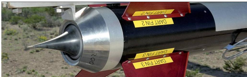
Figura 7 – Exemplo de foguete utilizando uma tubeira *aerospike*. (CALZADA, 2015)
