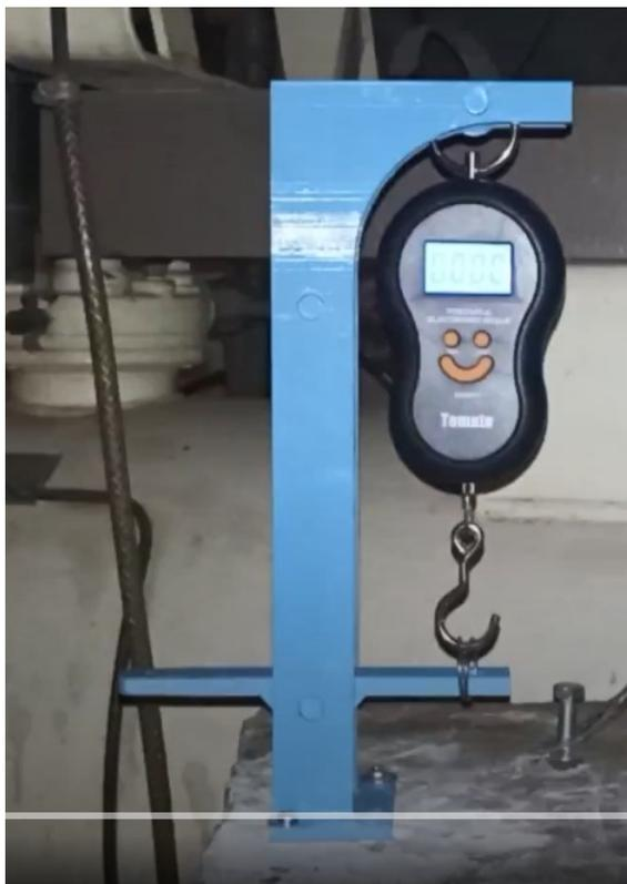
Figura 19 – Bancada de testes com a balança digital integrada
