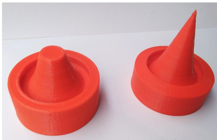
Figura 32 – Tubeiras *aerospike* toroidais truncada (a esquerda) e *full-length* (a direita)
