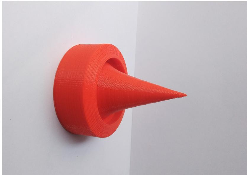
Figura 39 – Tubeira *aerospike* toroidais *full-length* em escala 1:2.
