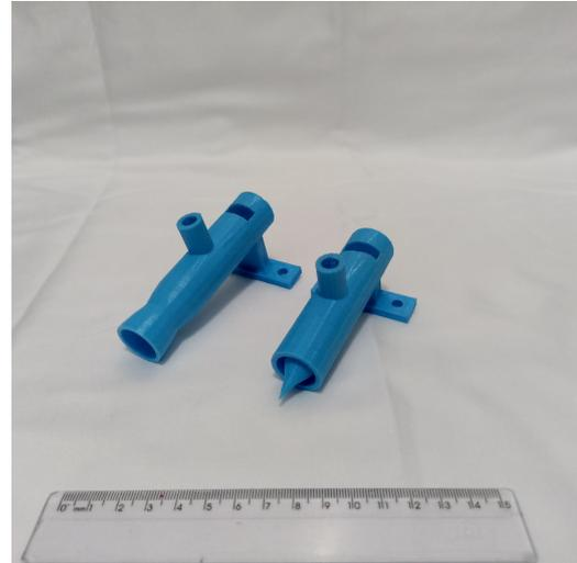
(b) Míssil *aerospike* à direita e *bell* à esquerda, com apoios
