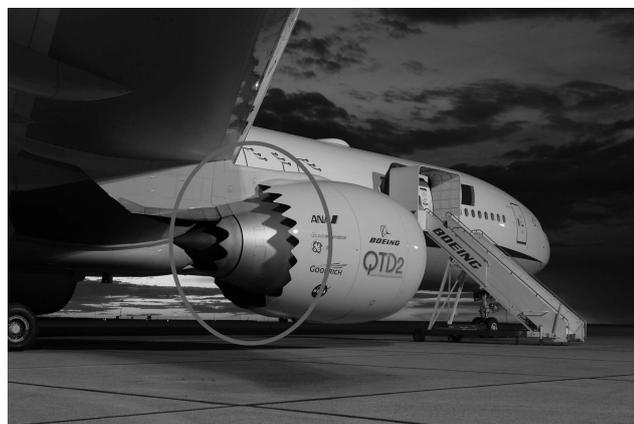
Figura 5 – Chevron montado ao final de nacele. Fonte: Banke (2017)
