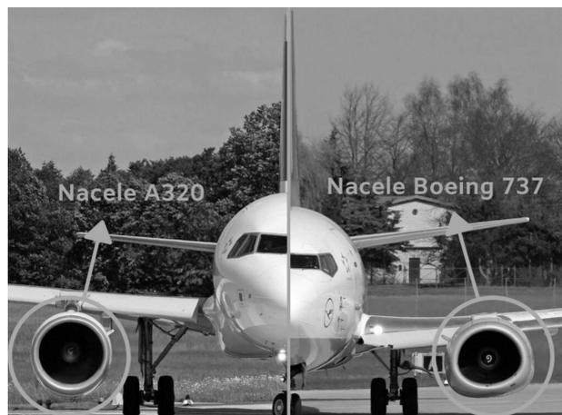
Figura 9 – A320 (esquerda) comparado ao Boeing 737 (direita). Adaptado de: Felix L. (2019)
