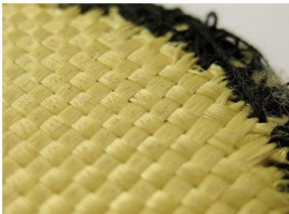
Figura 5 – Manta de Kevlar com orientação ortotrópica.
