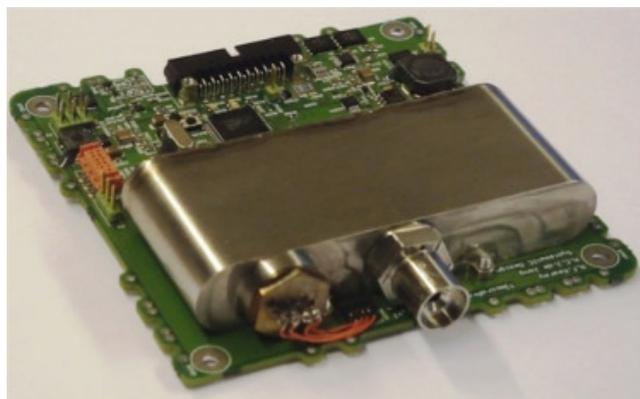
Figura 7 – Sistema de propulsão a gás frio do CubeSat 3U Delfi-n3xt.
