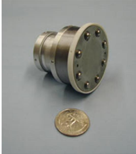
Figura 28 – Propulsor iônicos MiXI desenvolvido pelo JPL e pela UCLA.
