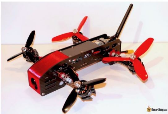
(a) Drone Aimdroix que possui a inclinação do braço ajustável ( LIANG, 2017 ).
