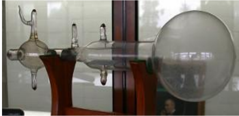
Figura 4 - Uma réplica do tubo de Crookes usado por J. J. Thomson em exposição na Universidade de Cambridge. Fonte: https://www.researchgate.net/figure/Figura-IV3-O-tubo-de-raios-catodicos-utilizado-por-Thomson-Fonte-Acervo-do-The_fig3_304080186
