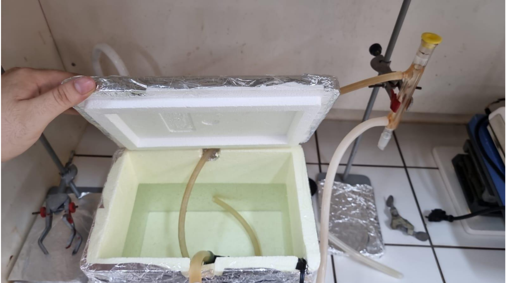
Anexo 16 – Interior do dispositivo de circulação de água
