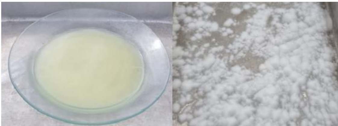
FIGURA 9 – Evolução da amostra 2 de sílica após 7 horas de exposição ao sol e ativação térmica
