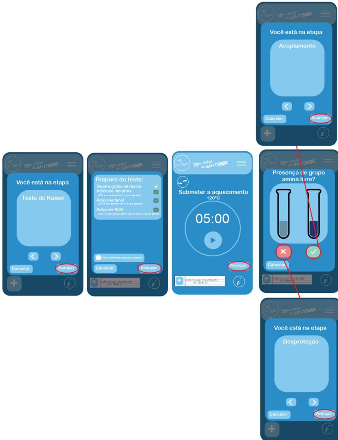
Figura 15: Ilustração da sequência de telas de execução de protocolo de teste de Kaiser implementadas no SolidP.
