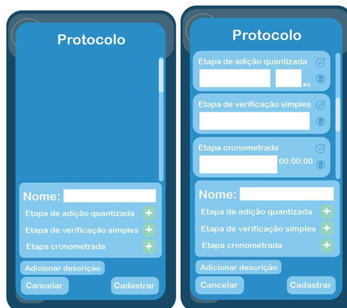
Figura 13: Ilustração da tela de cadastro de protocolo implementada no SolidP: à esquerda, uma tela anterior à adição de qualquer etapa e, à direita, um exemplo de cada tipo de etapa adicionada.
