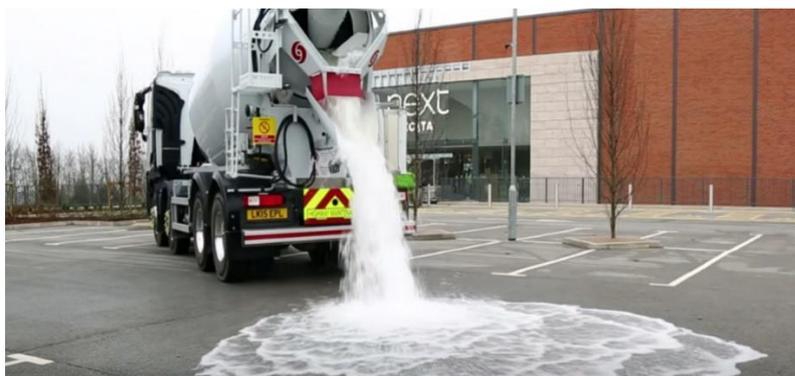
Figura 5. Demonstração de infiltração em pavimento permeável. Fonte: Tarmac, 2019.
