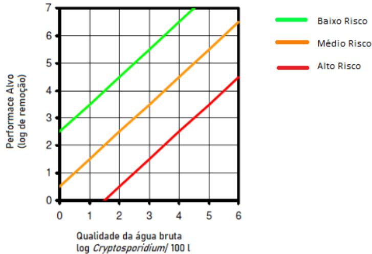
Figura 3.3 – Diagrama para determinar o nível de risco associado a uma instalação de tratamento com base na concentração estimada de oocistos de *Cryptosporidium* na água de origem e na eficiência (créditos de log) dos processos de tratamento. Modificada de OMS (2009)
