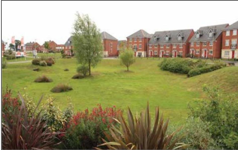
Figura 3.7 – Bacia de retenção com função paisagística em Hamilton, Leicester (Fonte: Ballard *et al.*, 2015).
