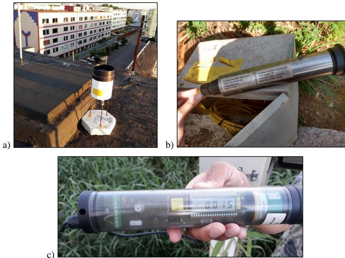
Figura 4.9 - Equipamentos para o monitoramento quantitativo: (a) pluviógrafo instalado no Cruzeiro Velho; (b) linígrafo de pressão instalado na galeria de entrada da lagoa; e (c) linígrafo de boia instalado na saída da lagoa.
