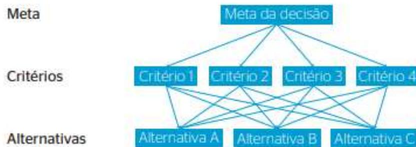
Figura 3.5: Elementos básicos da estrutura do AHP
