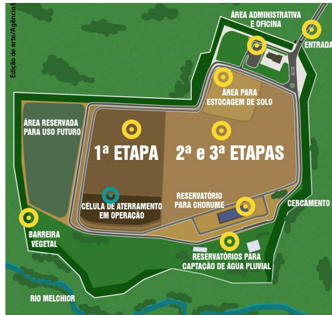
Figura 3.4 - Áreas de disposição de rejeitos e estruturas do Aterro Sanitário de Brasília
