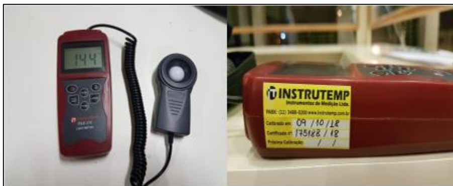
Figura 7- Luxímetro: Equipamento utilizado para medições da luz artificial.
