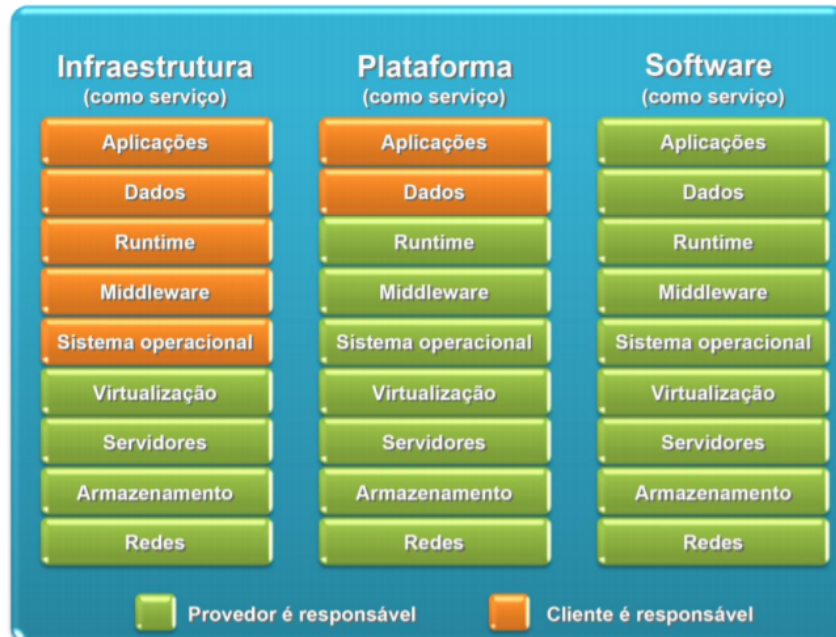
Figura 2.3: A diferença entre os três tipos de modelos de nuvem [2].
