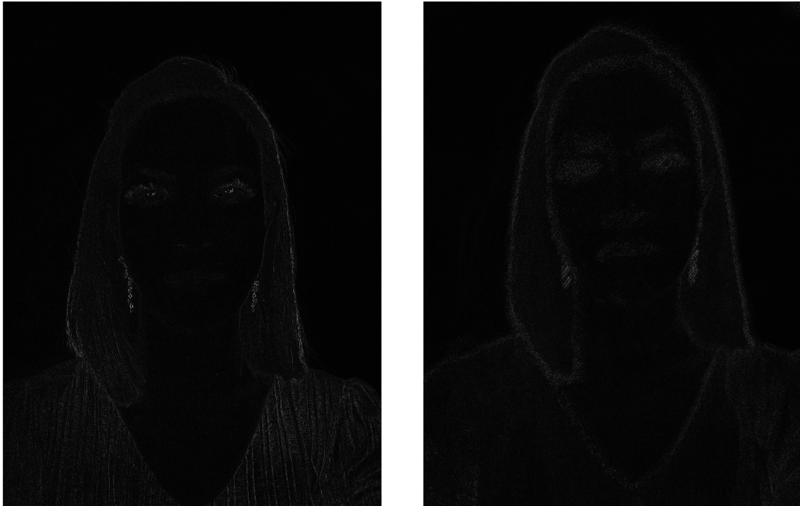
(a) Aplicação do filtro Laplaciano em imagem não borrada (b) Aplicação do filtro Laplaciano em imagem borrada
