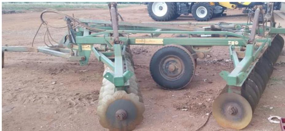
Figura 16. Grade leve usada para nivelar o terreno. Fonte: Arquivo do autor.
