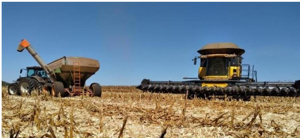
Figura 4. Conjunto de máquinas (trator com bazuca à esquerda e colheitadeira à direita) usadas na colheita do milho. Fonte: Arquivo do autor.
