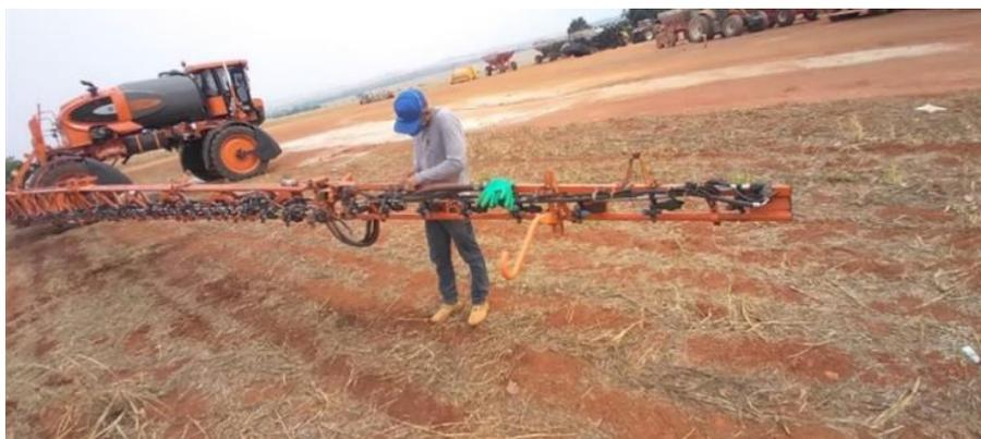
Figura 27. Técnico fazendo troca sensores de bicos. Fonte: Arquivo do autor.
