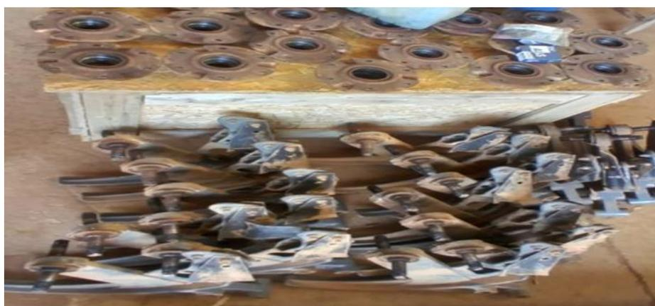
Figura 26. Rolamentos e condutores sendo trocados. Fonte: Arquivo do autor.
