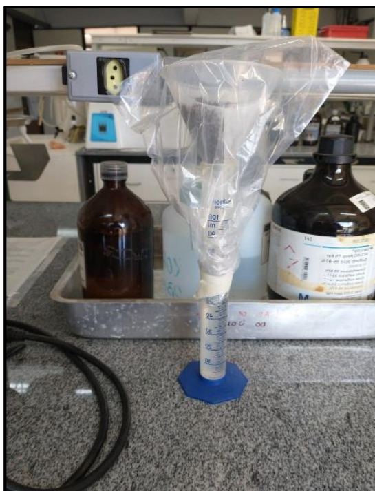
FIGURA 3 - Funil coberto com papel plástico contendo papel filtro e posicionado dentro de uma proveta graduada de 100 mL com 20g do substrato Carolina Soil e 100 mL de água destilada.
