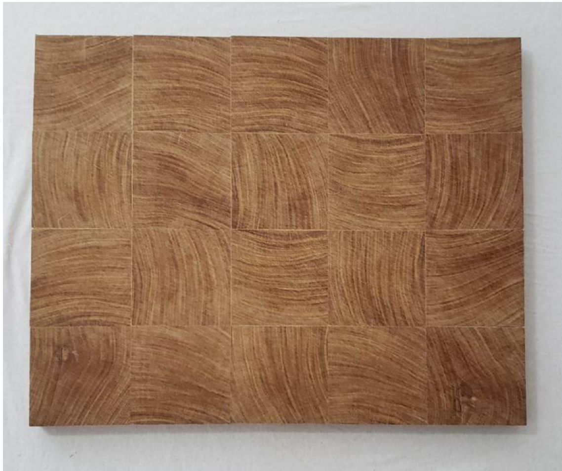
Figura 25: Blocos colados secos.
