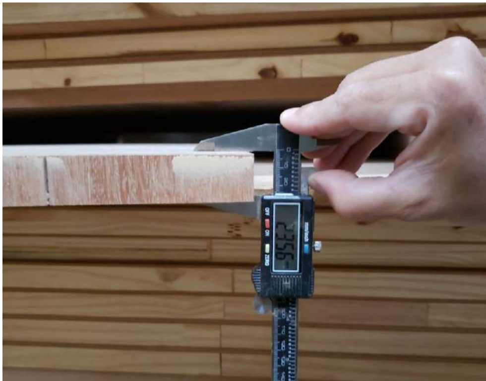
Figura 27: Paquímetro digital medindo 23,56mm.
