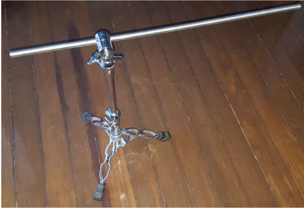
Figura 2.14: Suporte provisório dos módulos motorizados utilizando um pedestal de bateria - Fonte: Autor
