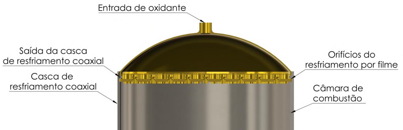
Figura 108 – Representação do sistema de resfriamento e injeção
