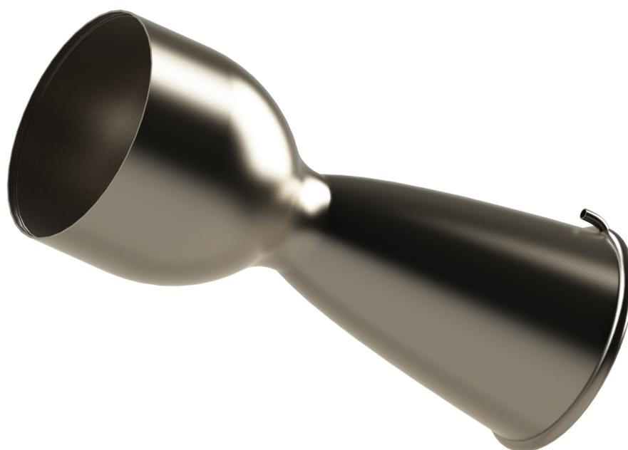
Figura 100 – Modelo 3D da câmara de combustão e da tubeira
