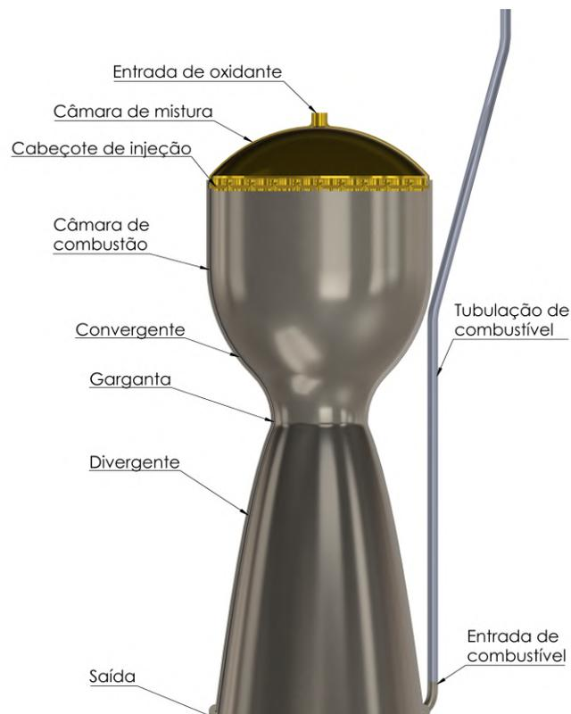
Figura 110 – Modelo 3D do sistema propulsivo completo
