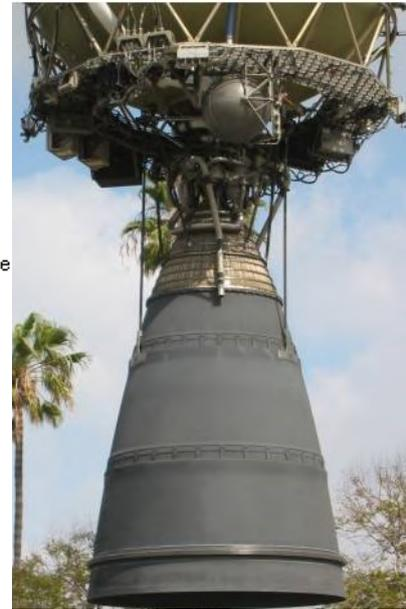
Figura 134 – Esquemático e foto do motor RL-10B-2-1A
