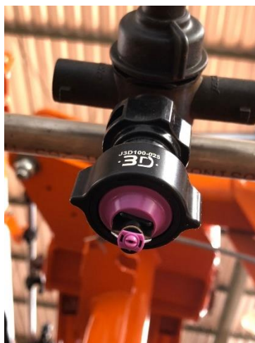
Figura 5 - Bico de pulverização Jaco® J3D 100.0,25 lilás
