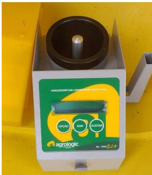
FIGURA 6 - Equipamento utilizado para determinar umidade do grão-de-bico a campo. (Letícia Alves Mariano, 2020)
