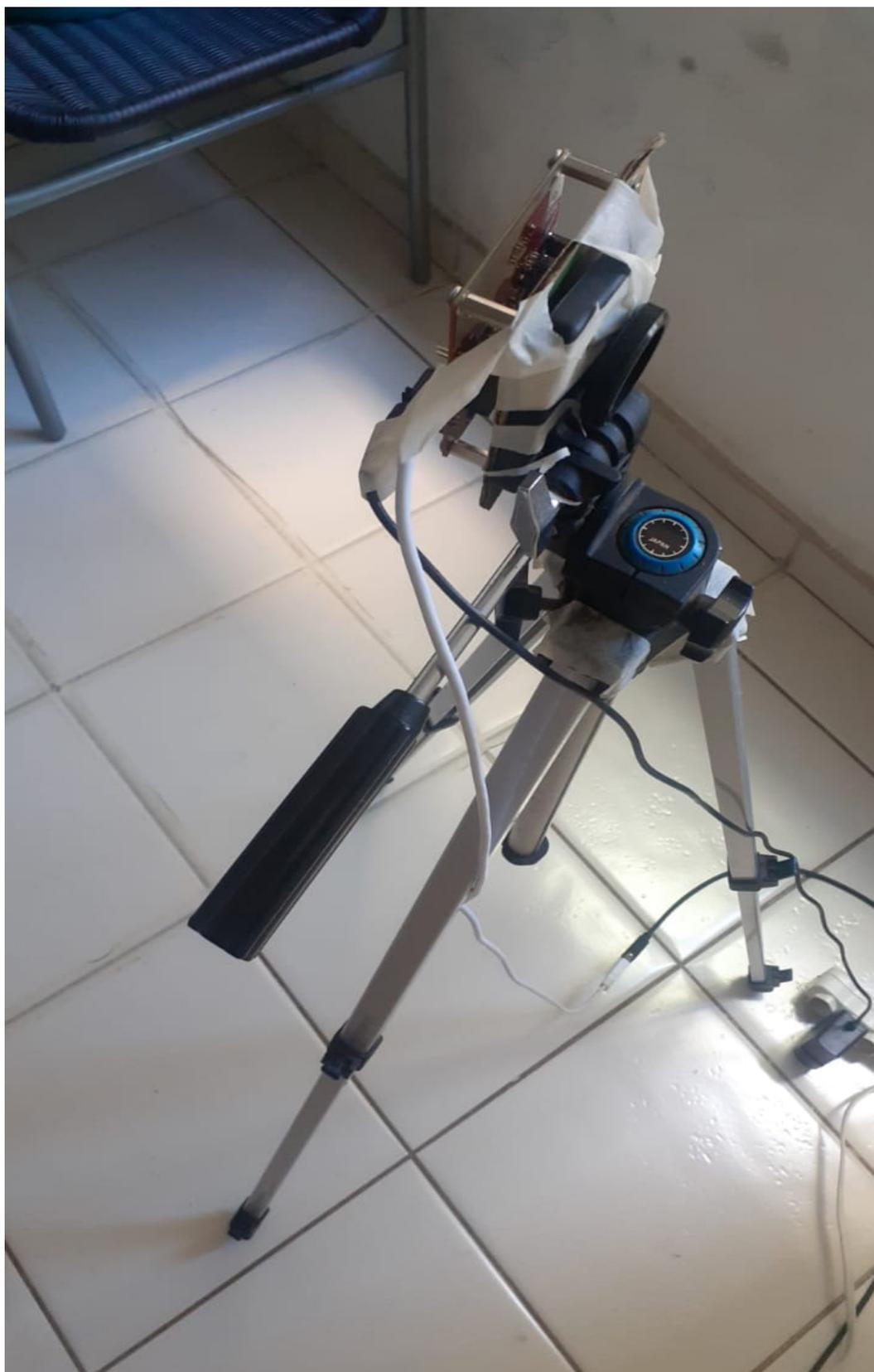
Figura 3.4 – fixação do sensor no tripé
