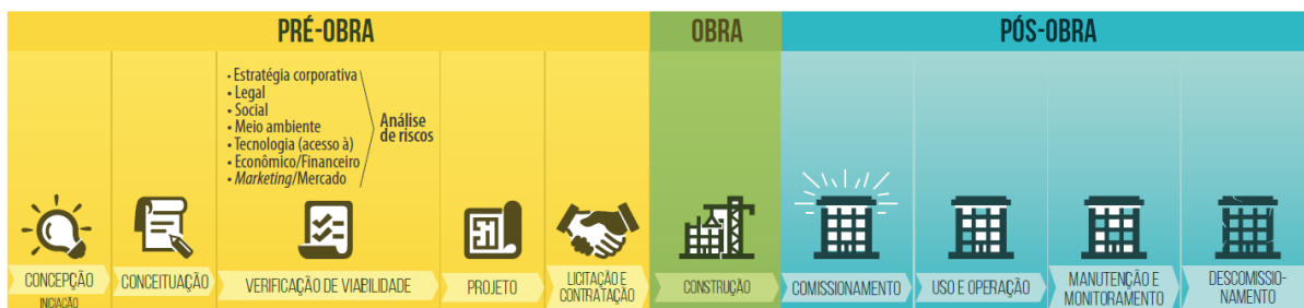
Figura 2.1 - Representação do ciclo de vida de um empreendimento típico da construção civil
