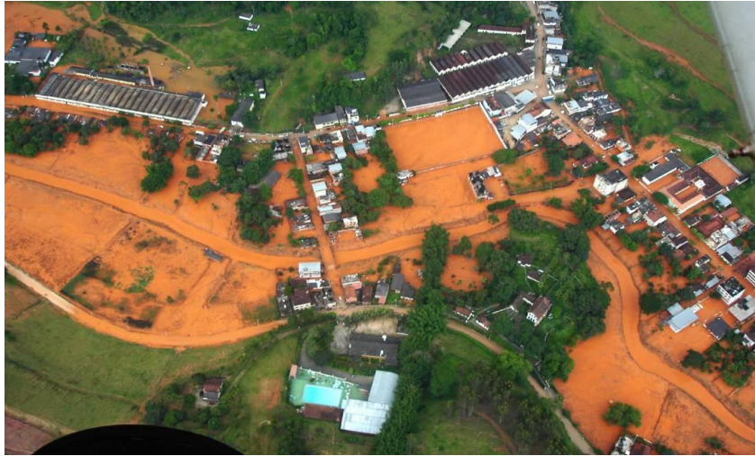
Figura 2.9 – Corrida de lama de rejeitos após ruptura da Barragem de Rio Pomba Cataguases em Mirai, Minas Gerais (BARRETO, 2007)
