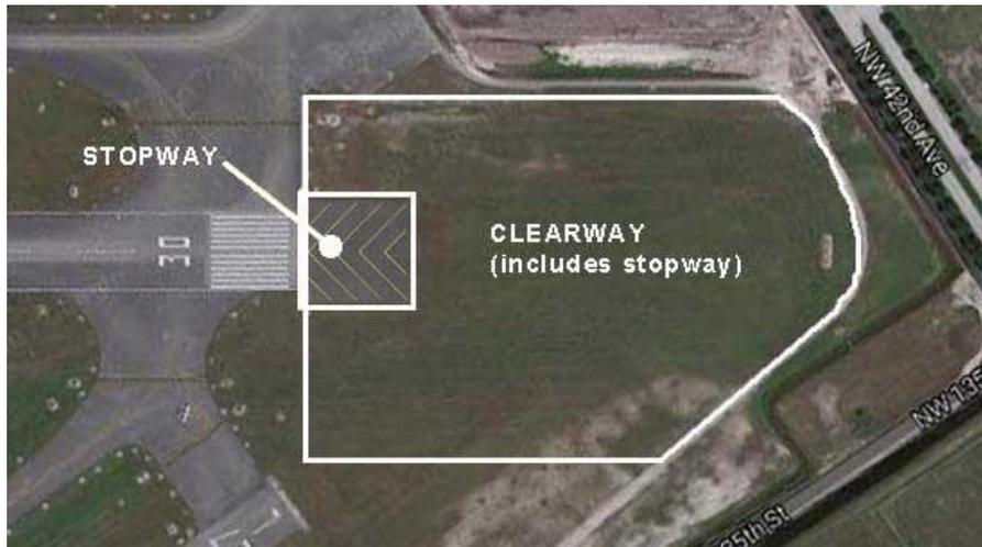
Figura 4.2 – Construção de uma zona de parada pavimentada (*stopway*) e a delimitação de uma zona livre de obstáculos (*clearway*).
