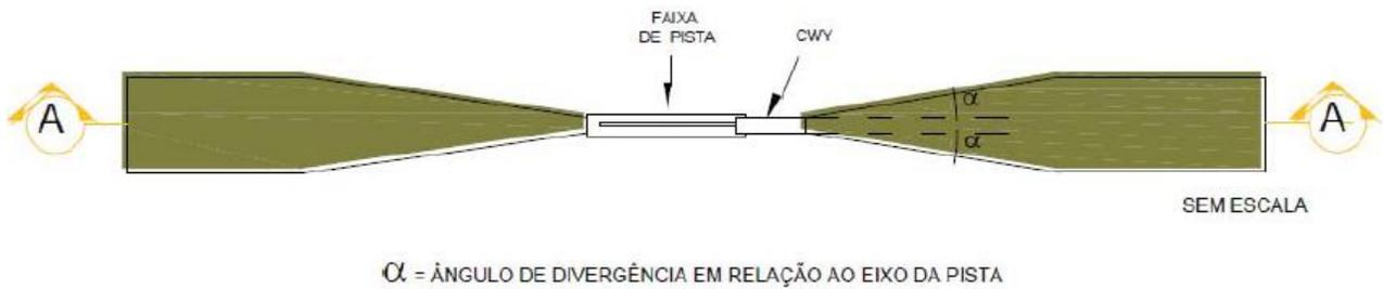
Figura 2.16 - Dimensões da Superfície de Decolagem (BRASIL, 2015).
