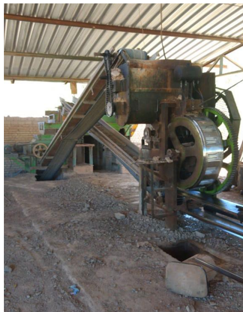
Figura 18 – Máquina utilizada para mistura entre água e argila e moldagem dos produtos cerâmicos (Olaria Santa Fé)
