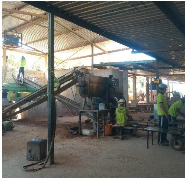
Figura 6 – Máquina utilizada para mistura entre água e argila e moldagem dos produtos cerâmicos (Olaria 3 Irmãos)
