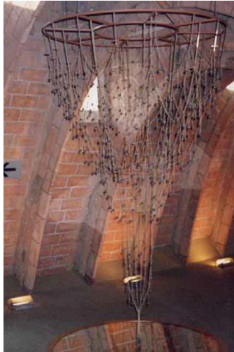
Figura 2.99 – Modelo de Gaudí para o dimensionamento de cúpulas Fonte: Gago, 2004
