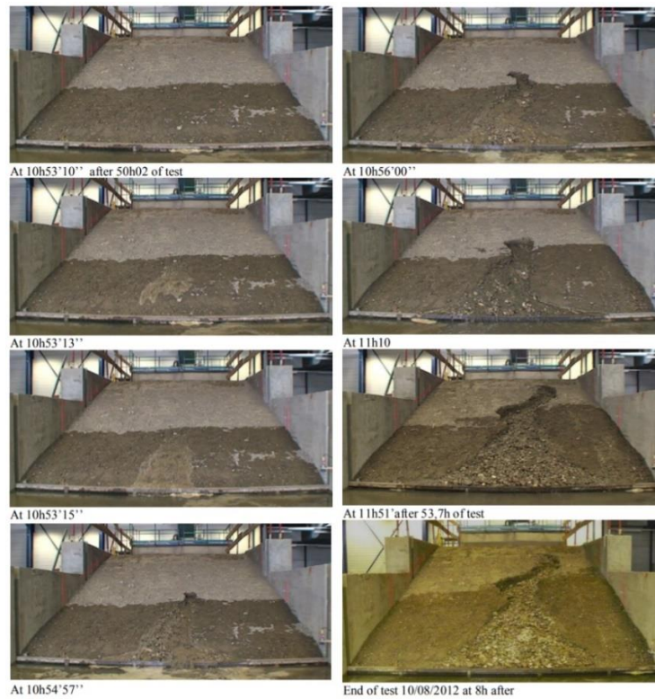
Figura 2-11: Erosão Regressiva Global em Ensaio de Laboratório (FRY, 2016).
