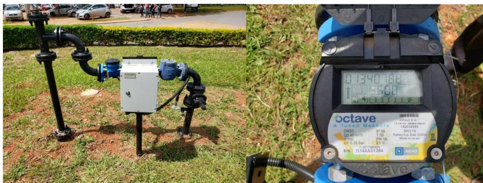
Figura 4.6 - Hidrômetro completo com o Sensor Ultrassônico
