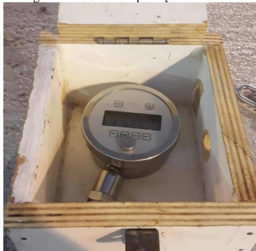
Figura 4.5 - Caixa de proteção com o manômetro
