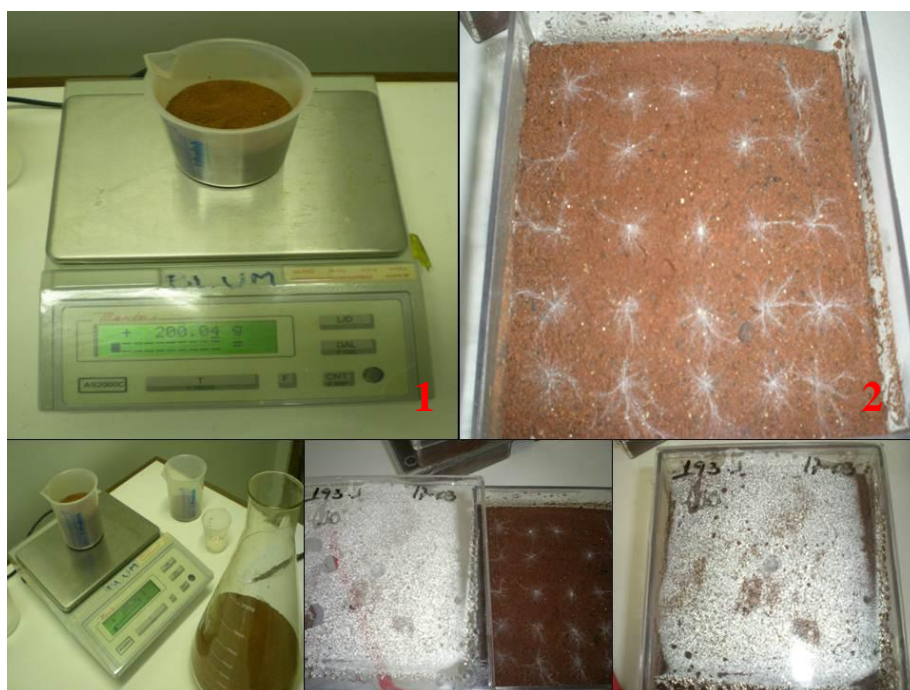
Figura 4. (1) Pesagem do solo para montagem do experimento em recipiente tipo-gerbox®; (2) Organização dos esclerócios sobre a superfície do solo.
