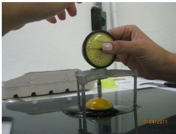
Figura 5 - Medição de altura de gema utilizando micrômetro.
