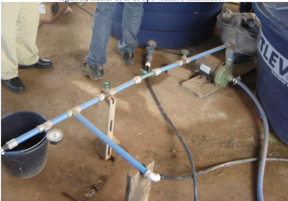
Figura 11. Conjunto de teste constando de reservatórios, motobomba, mangueiras, registros, indutor de ar do tipo venturi e manômetro.
