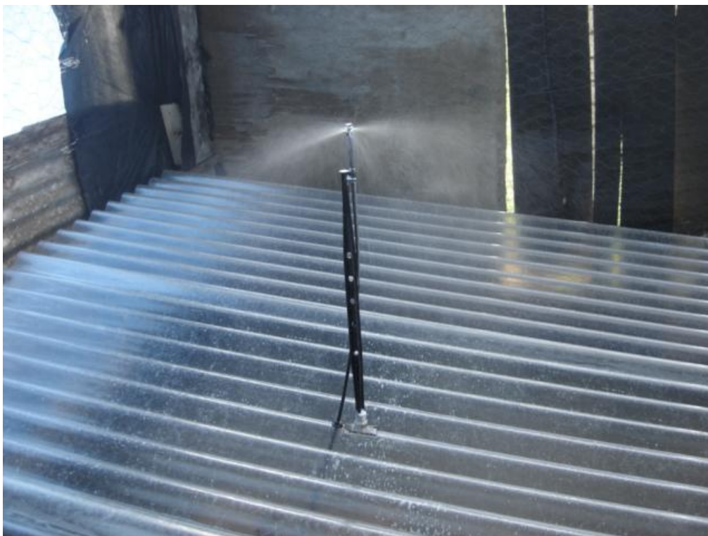
Figura 9. Detalhe do microaspersor da Rain bird modelo QN-05 preto “E”.
