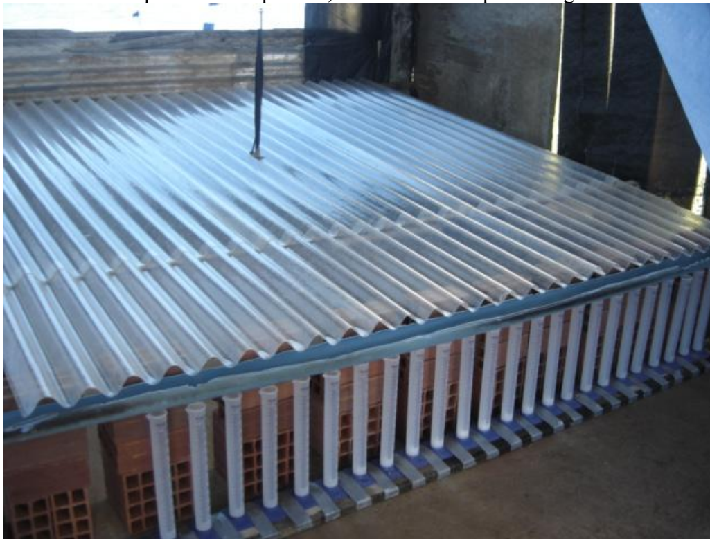
Figura 12. Conjunto de teste constando de microaspersor, superfície coletora com seis telhas de plástico transparente, calha coletora e provetas graduadas.
