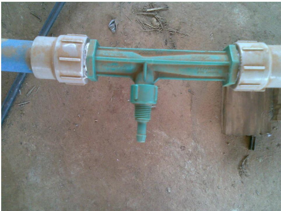
Figura 8. Detalhe do aparelho venturi modelo 584 MIC \frac{3}{4} BSPT.
