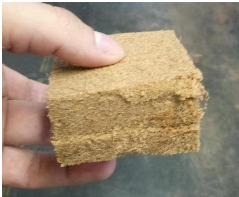
Figura 4.19: Corpo de Prova de Areia + 1,0% de Fibras
