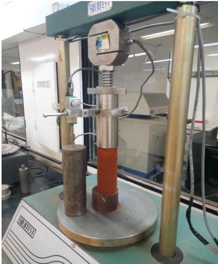
Figura 3.9: Ensaio de Compressão Simples (Fonte: Autor)
