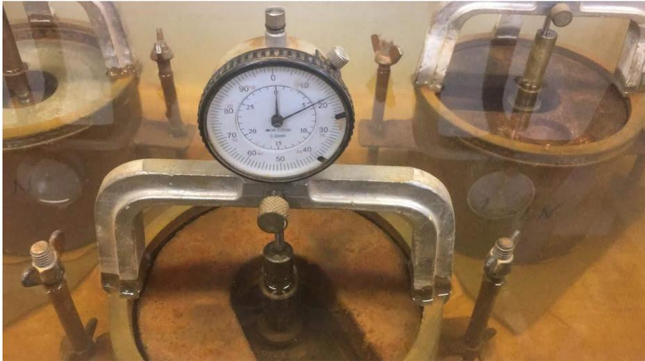
Figura 3.8: Ensaio de Expansão (Fonte: Autor)
