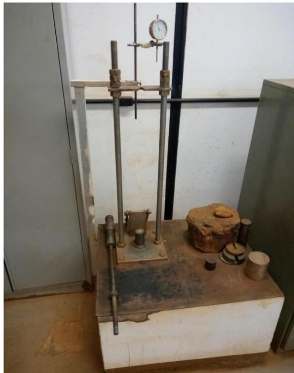
Figura 3.6: Equipamento para Compactação Miniatura (Fonte: Autor)
