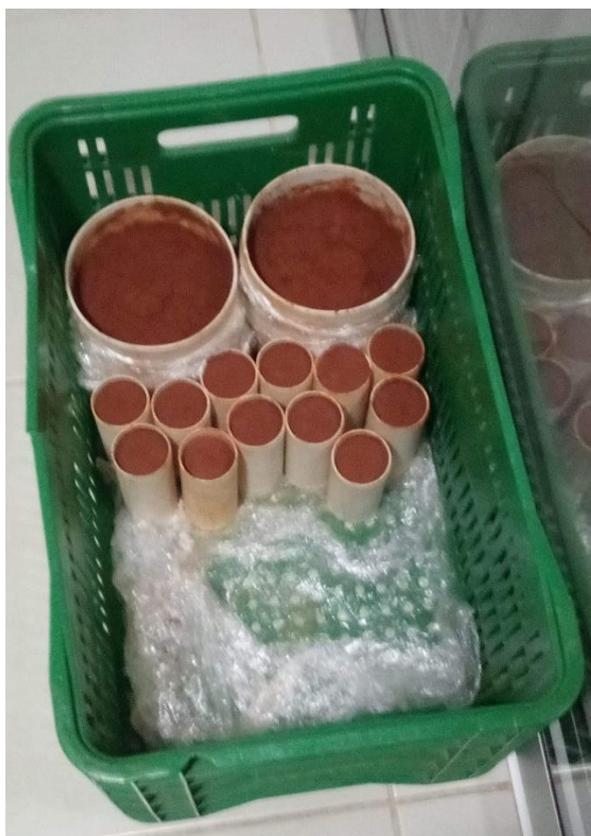
Figura 3.7: Corpos de Prova Miniatura e Proctor Normal
