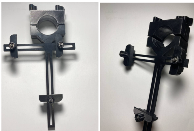
Figura 38 – Adaptador de acoplamento entre smartphone e ocular do microscópio.
