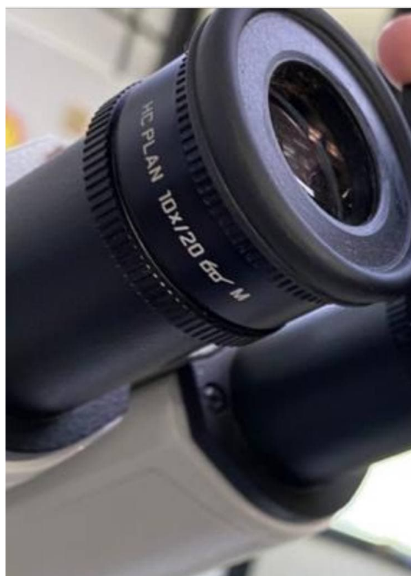
Figura 29 – Ocular do microscópio utilizado com sua marcação de ampliação e número de campo.
