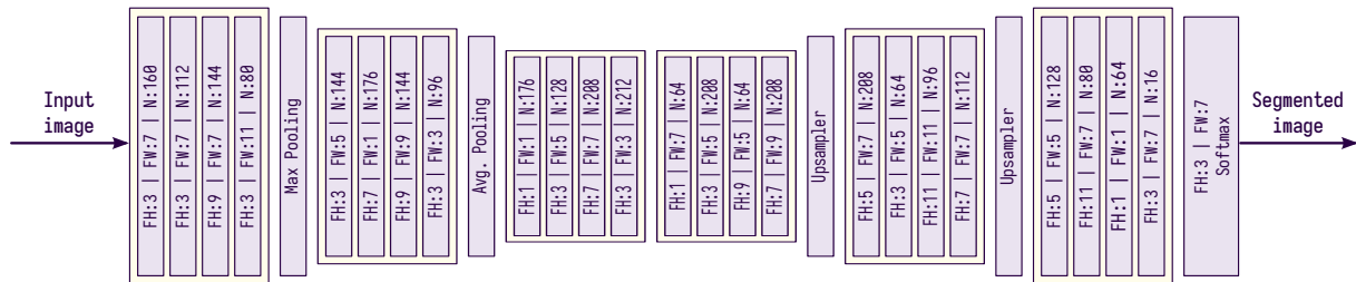
Figura 3.2: Arquitetura otimizada encontrada a partir da busca de hiperparâmetros por Mortazi e Bagci (2018). A abreviação Avg. corresponde a média (Adaptado: (MORTAZI; BAGCI, 2018)).
