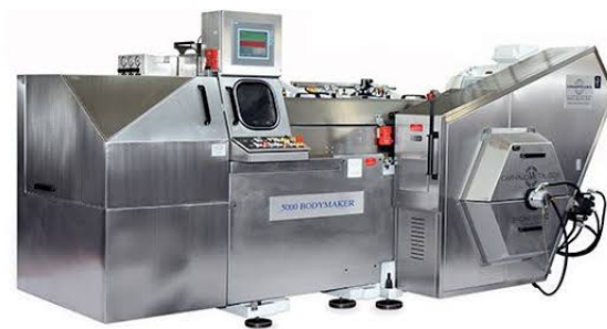
Figura 22 – Máquina CMB5000 Bodymaker . Fonte: CarnaudMetalbox Engineering website .
