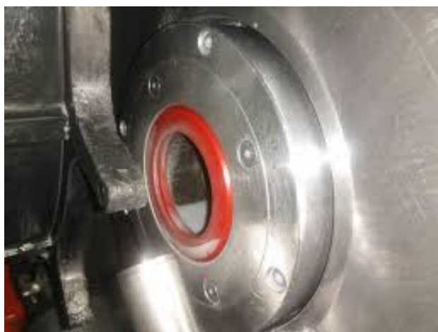
Figura 25 – Exemplo de instalação do retentor de vedação hidráulico junto ao conjunto Domer da Bodymaker . Fonte: Fotografia tirada por mecânico de campo.
