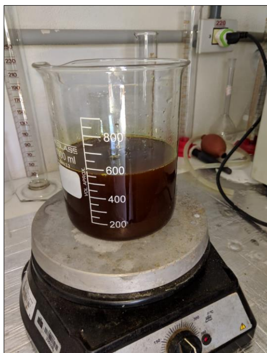
Figura 19 – Preparação do Precursor Polimérico contendo NPOF segundo método de Pechini.
