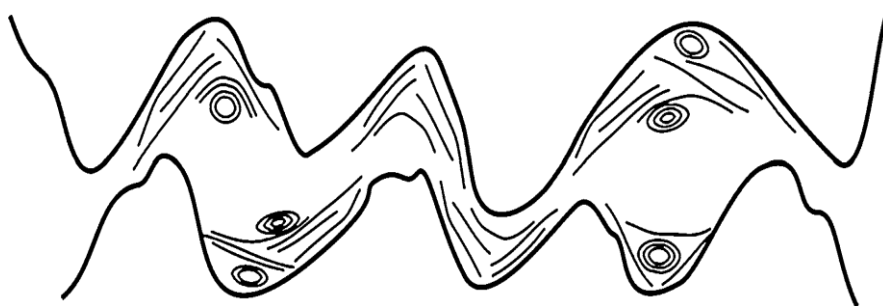
Figura 14 – Ilustração do mecanismo de efeito de polimento. (KALIN et al. 2012)
