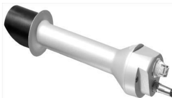
Figura 13: Pireliômetro Kipp & Zonen Modelo CHP 1.
