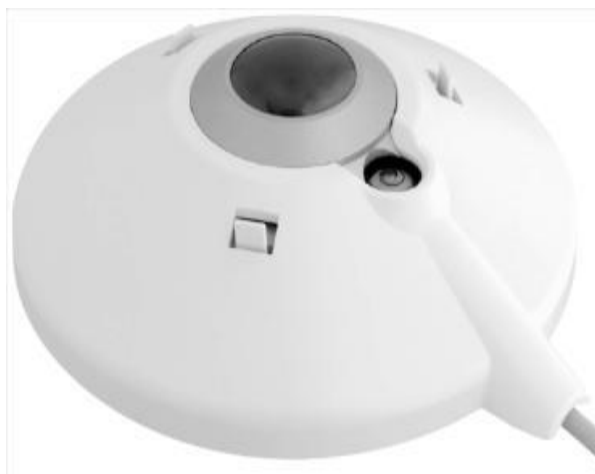
Figura 12: Pirgeômetro Kipp & Zonen Modelo CGR 4.
