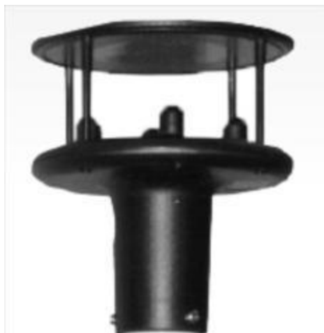
Figura 16: Anemômetro Ultrassônico 2D Campbell Scientific modelo windsonic1-L.
