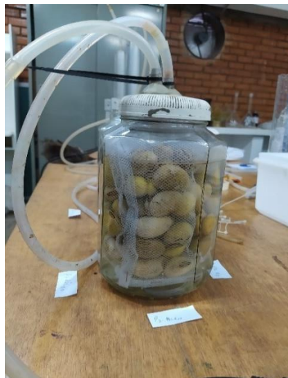
Figura 6- Recipiente cilíndrico utilizado na ozonização com água. Fonte: autoral.
