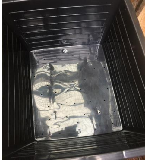
Figura 7 – Furos nas caixas digestoras para passagem do biochorume e movimentação das minhocas. Fonte: Pereira, 2019.
