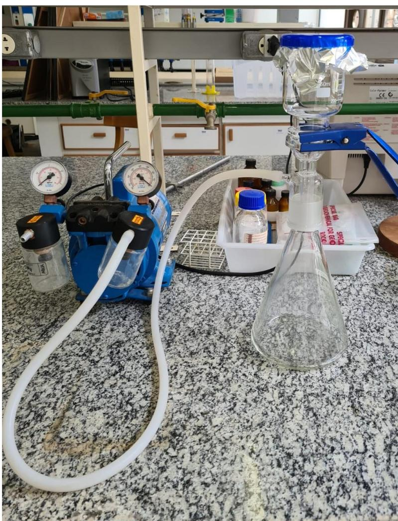
**Figura 18** – Aparato usado para filtração a vácuo das amostras em membrana de éster de celulose.
