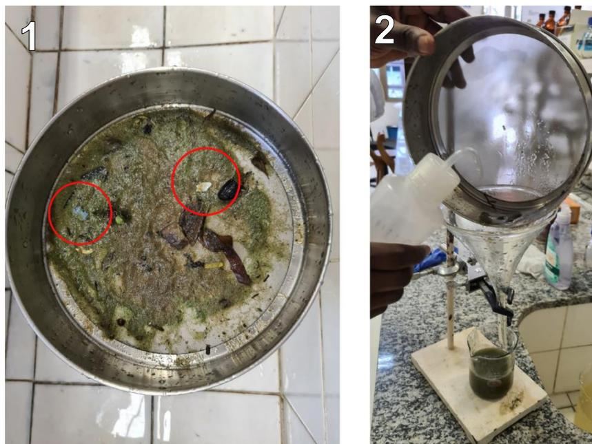
**Figura 14** - Peneiramento das amostras. 1) Mesoplásticos presentes na amostra RB; 2) Transferência da amostra para o béquer com o auxílio de um funil.
