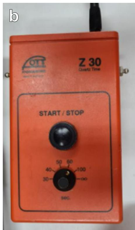
**Figura 5** - Micromolinete acoplado na haste de medidas (a) e contador OTT Hydrometrie Z30 (b).
