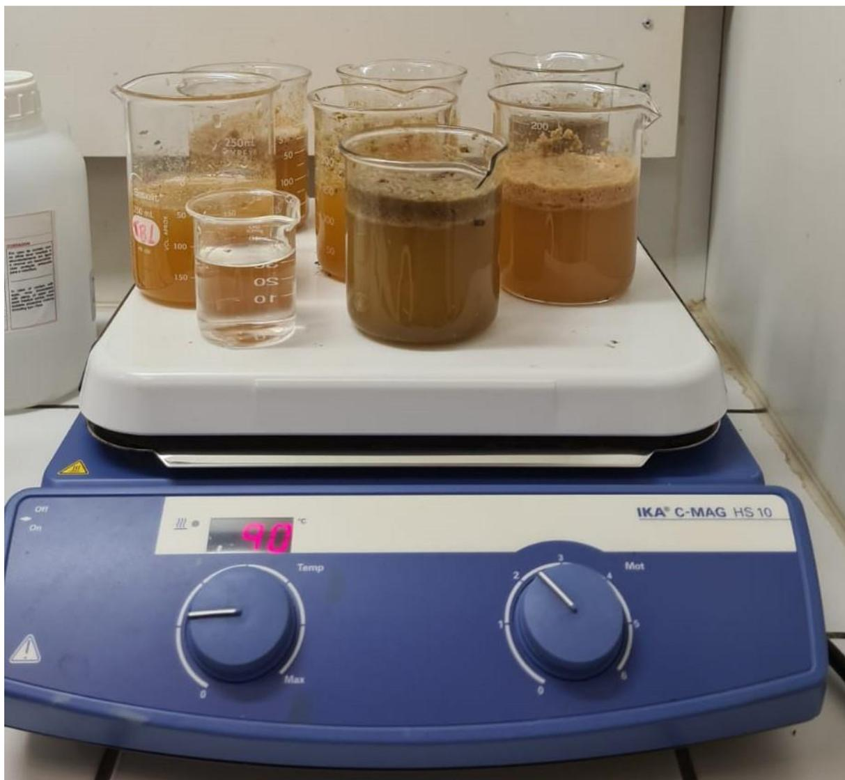
**Figura 15** - Amostras na placa de aquecimento para digestão da matéria orgânica interferente.
