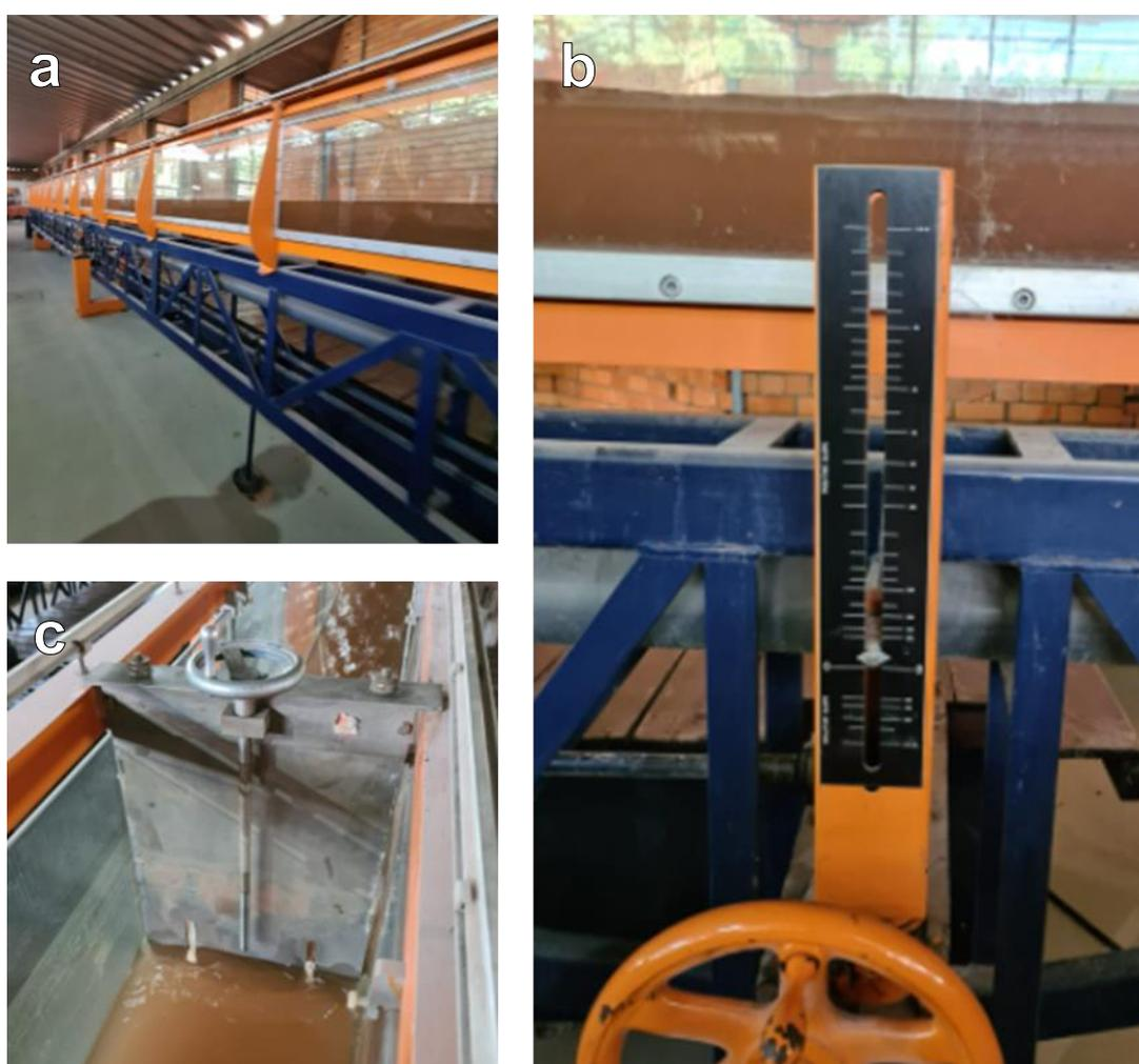
**Figura 6** - Canal com declividade variável (a) com controlador de declividade (b) e acessório utilizado para alterar a profundidade e velocidade do fluido (c).
