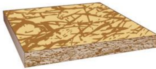
Figura 4 – Peça ilustrativa de Laminated Strand Lumber (LSL). Fonte: naturally:wood (2021)
