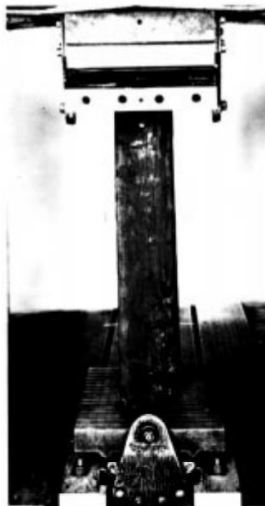
Figura A2 – Ensaio de compressão paralela. Fonte: Seção 15.2 da ASTM D 198-99.
