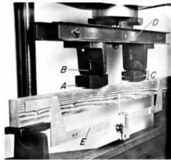
Figura A1 – Ensaio de flexão. Fonte: Seção 7.3.1 da ASTM D 198-99.
