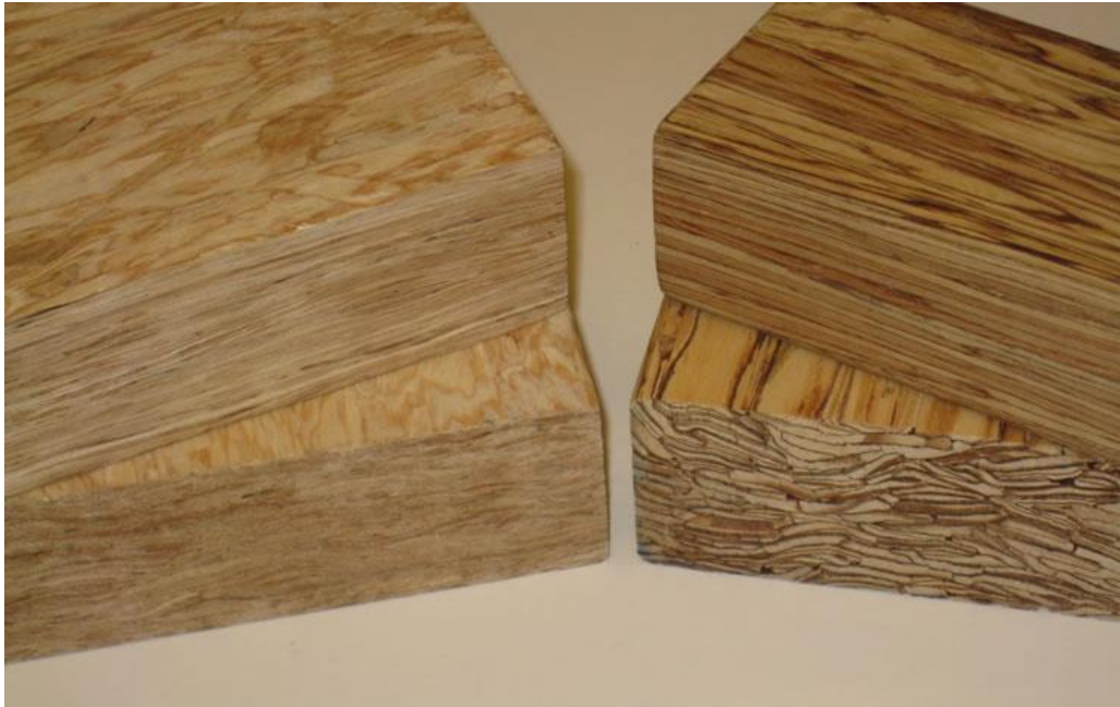
Figura 5 – Peças ilustrativas e comparativas de Oriented Strand Lumber (OSL) à esquerda e Parallel Strand Lumber (PSL) à direita. Fonte: Government of Canada (2021)
