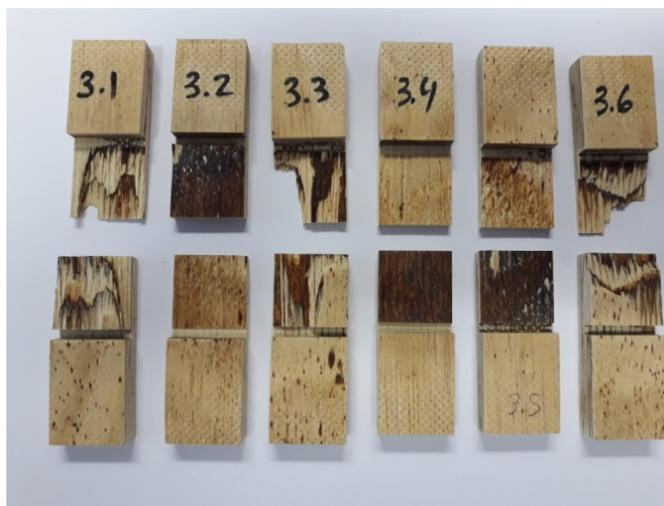
Figura 5 - Aspectos da ruptura dos corpos de prova PT3 após teste de  $f_{gv,0}$ .
