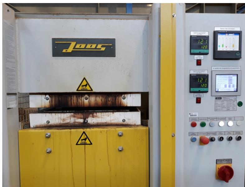
**Figura 1 - Equipamento de Prensagem Joos Lap 150**
